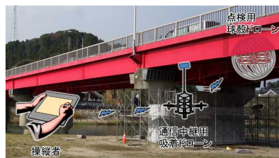
通信中継ドローンの運用イメージ
