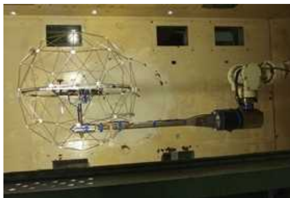
風洞での空力性能試験
