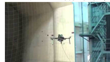
JAXA風洞での飛行性能評価
