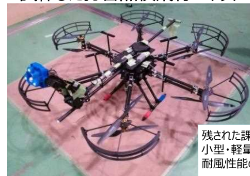
試作した打音点検飛行ロボット
