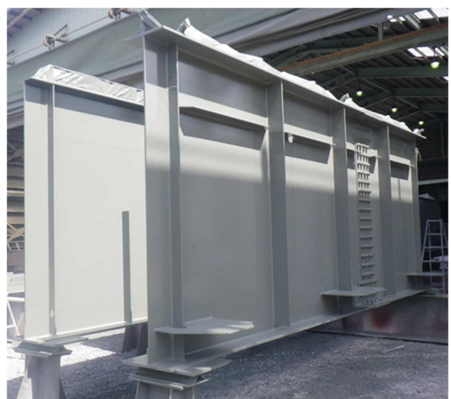
写真 1 塗装後の鋼桁モデルの主桁
