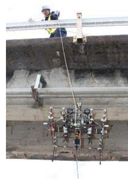
打音装置やカメラを搭載したドローンで橋の裏側を点検する担当者＝美濃市上野で
