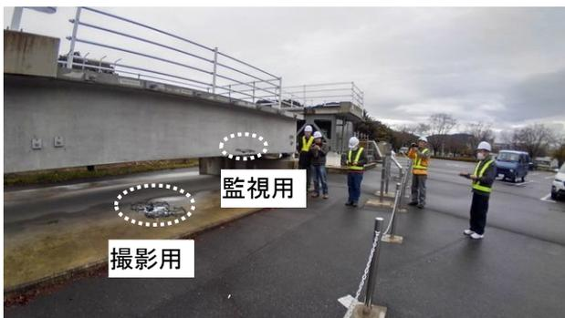
図-22 目視外飛行での安全性確保
