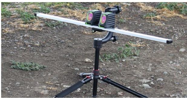
図-11 寸法計測用レーザー照射装置
