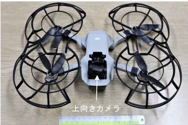
図-2 カメラを上向きに取付けた改造機
